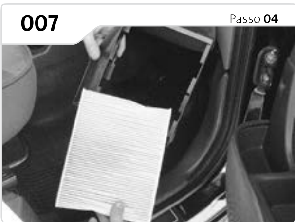
Faça a troca do filtro substituindo o antigo encaixado no trilho da carenagem.
