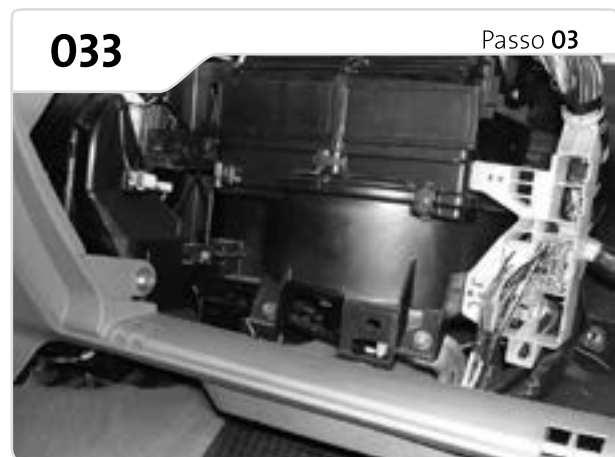
Localize a área indicada e faça o corte seguindo o relevo do plástico.
