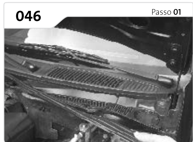
Retire a borracha de vedação.
