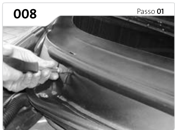
O filtro está localizado sob o capô. Retire os parafusos da carenagem de plástico conforme indicado.
