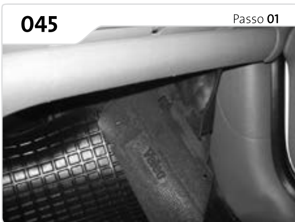
Retire a proteção localizada abaixo do porta-luvas.
