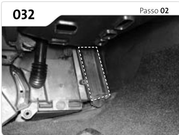
Pressione as travas, remova a tampa e faça a troca do filtro.
