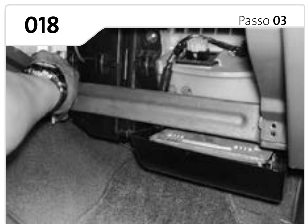
Retire o porta-luvas por completo, localize e puxe a tampa conforme indicado.
