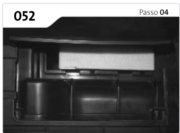
Coloque o filtro novo.
