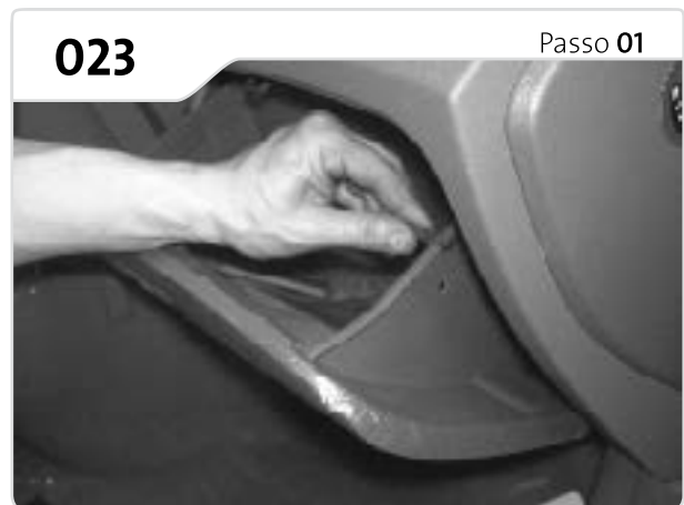
O filtro está localizado atrás do porta-luvas. Abra e remova o limitador.
