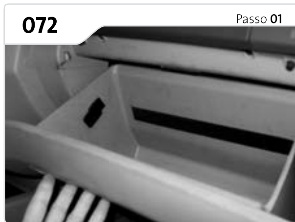
O filtro se encontra atrás do porta luvas - solte as travas e baixe o porta-luvas.
