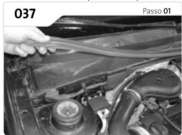
Remova os parafusos do lado esquerdo sob o capô e retire a borracha de vedação.
