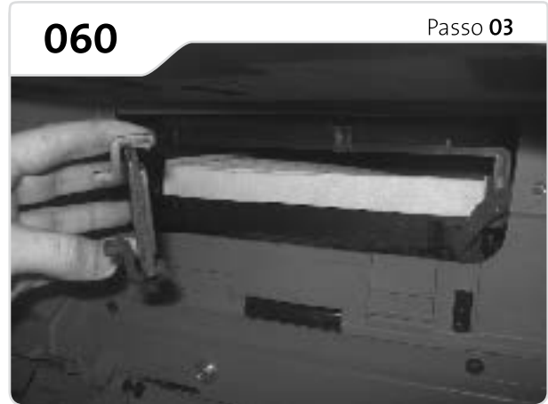
Faça a troca pelo filtro novo e feche com a presilha.
