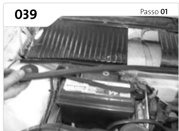
O compartimento está localizado ao lado esquerdo sob o capô. Retire a borracha de vedação.
