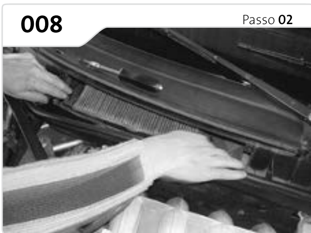
Retire a tampa para acesso ao filtro.
