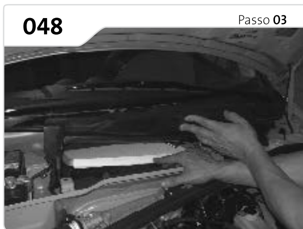
Levante o compartimento do filtro e efetue e troca.
