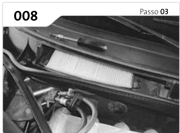
Destrave as presilhas que seguram o filtro de cabine central.
