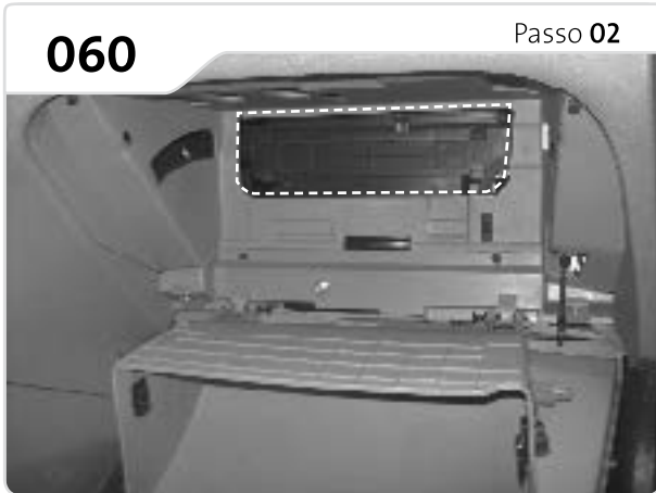
Veja na marcação o local onde encontra-se o filtro.
