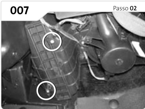
Retire os parafusos.
