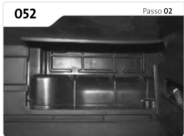
Remova a proteção interna.
