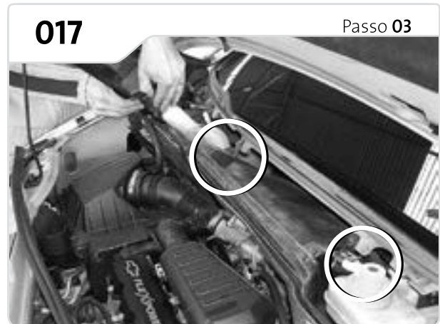
Puxe a borracha de vedação, retire completamente a carenagem plástica e retire os parafusos indicados.
