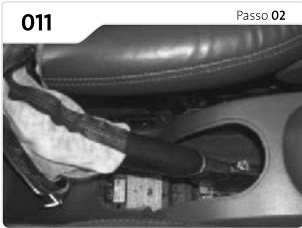
Retire o acabamento do freio de mão.
