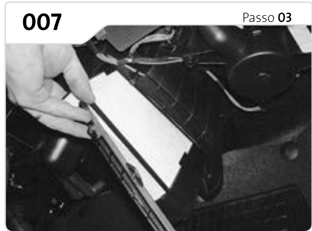
Retire a tampa com o trilho.
