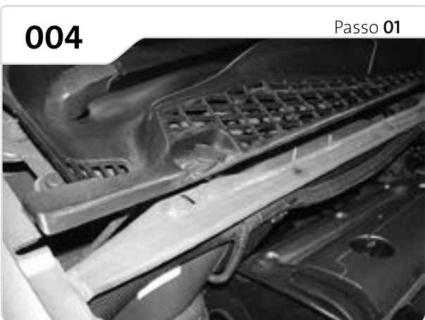
O filtro da cabine está localizado sob o capô ao centro.
