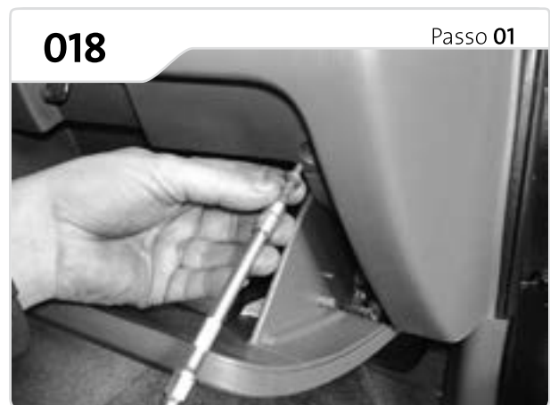
O filtro de cabine está localizado atrás do porta-luvas, retire o parafuso indicado.
