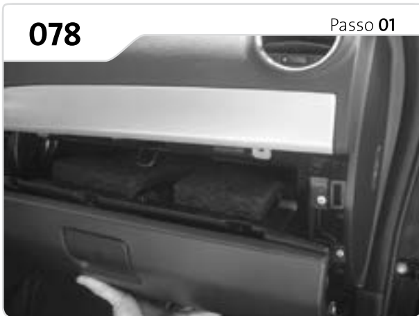
Retire os parafusos ao redor do porta-luvas e o retire.
