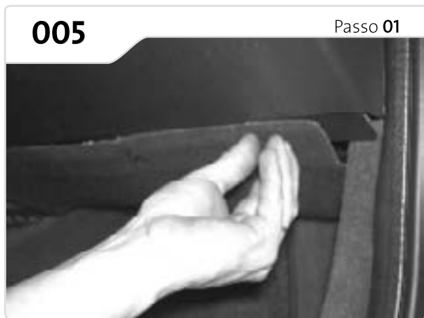
O filtro está localizado embaixo do porta-luvas. Retire as travas.
