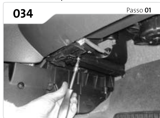
Remova os parafusos do lado esquerdo sob o porta-luvas, no caso de presilhas apenas retire a tampa. Obs.: Caso o habitáculo esteja lacrado, recorte e instale a tampa original 6Q0.819.422B (encontrada nas concessionárias).
