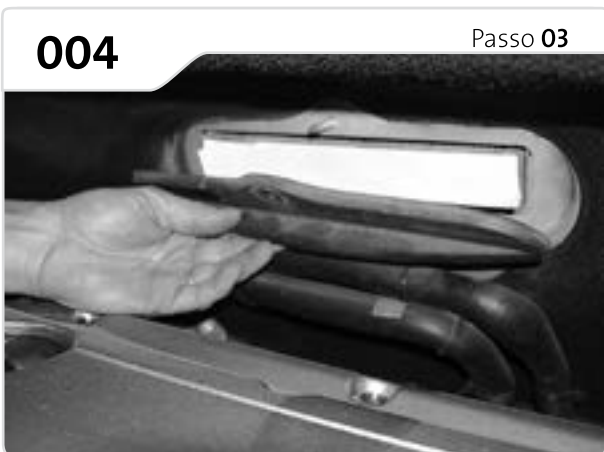
Retire a tampa de plástico.
