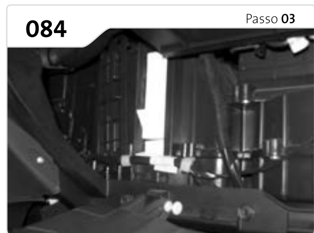
Faça a troca colocando um filtro por vez.
