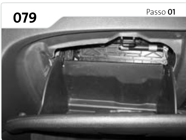
O filtro está localizado atrás do porta-luvas. Pressione as laterais e o puxe.
